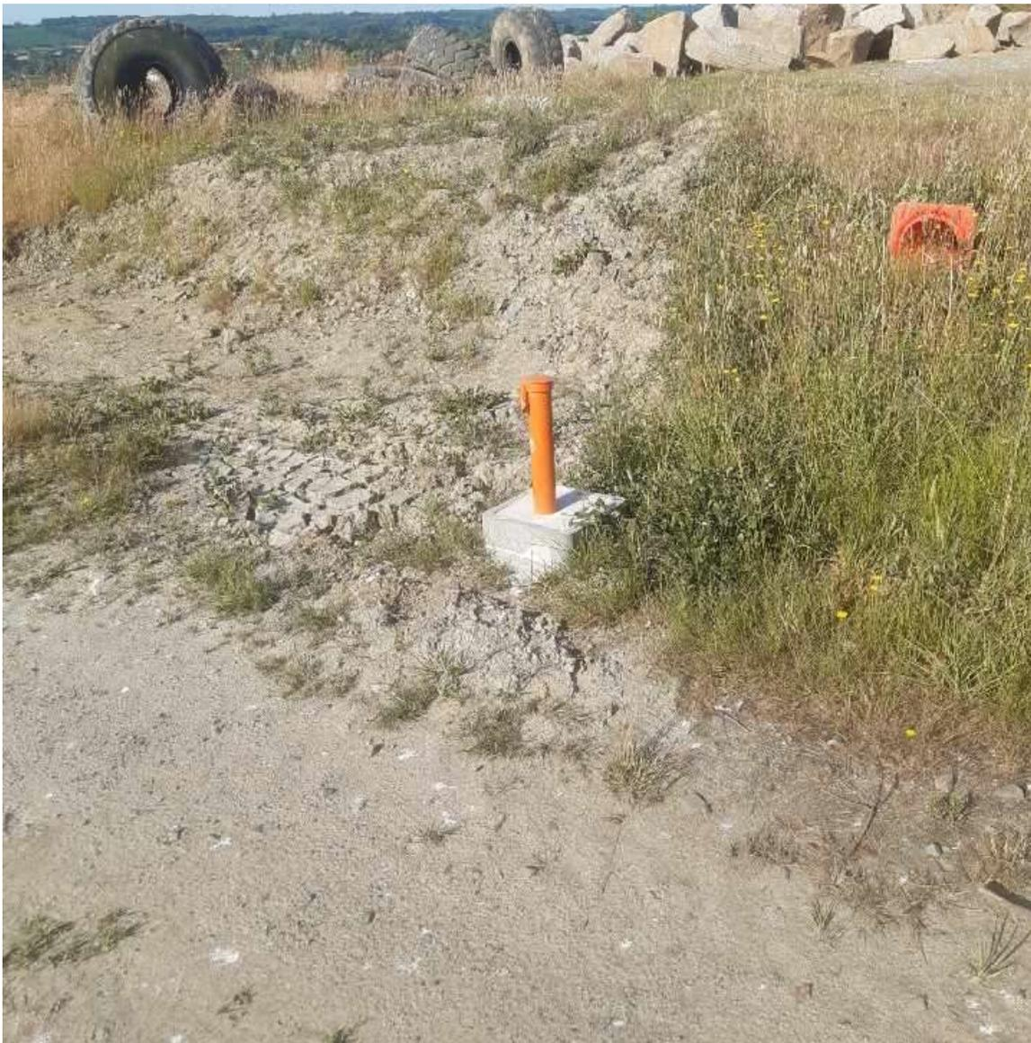
Piezomètre n°4 suite à l'opération de reforage réalisée par l'entreprise Fond Ouest.
